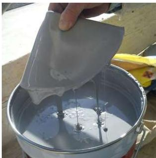
Wurde ein Gebinde nicht 100%ig dicht verschlossen kann Luftfeuchtigkeit eindringen und dadurch beginnt das Material an der Oberfläche zu reagieren. Es trocknet pro 24 Stunden in einer Stärke von ca. 1,0 mm.
