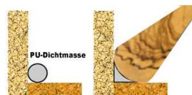
Die PU-Dichtmasse **"HYPERSEAL-Expert"** trocknet durch die Aufnahme von Luftfeuchtigkeit. Sie sollte abschnittsweise (ca. 1 bis 2 Laufmeter) aufgebracht und sofort geglättet bzw. modelliert werden, denn es bildet sich nach ca. 5 Minuten ein minimaler Trockenfilm an ihrer Oberfläche.
