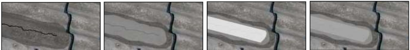
**Der Rissbereich wird grundiert - mit Flüssigkunststoff bestrichen - der Gewebestreifen wird aufgelegt - festgedrückt und getränkt.**
